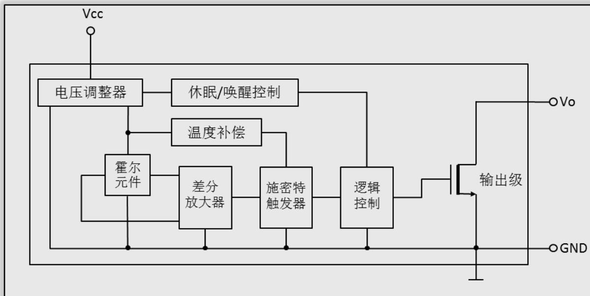
传感器芯片集成有电压调整器、霍尔电压发生器、动态失调电压补偿器、温度补偿器、唤醒/休眠控制器、差分放大器、施密特触发器、逻辑控制器以及漏极开路输出驱动器等电路单元。
