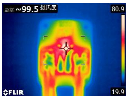
封装体热成像图（输入电流 40A）
