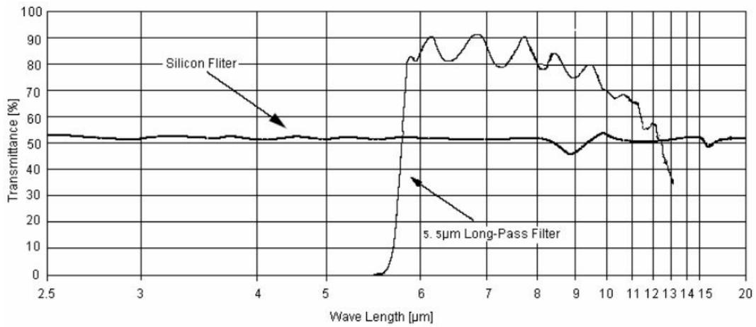
注意：图表所示为典型的 5μ m 红外滤光片参考图，曲线是红外线通过率平均值。该窗口材料是经过特殊真空镀膜处理过的半导体硅片。
