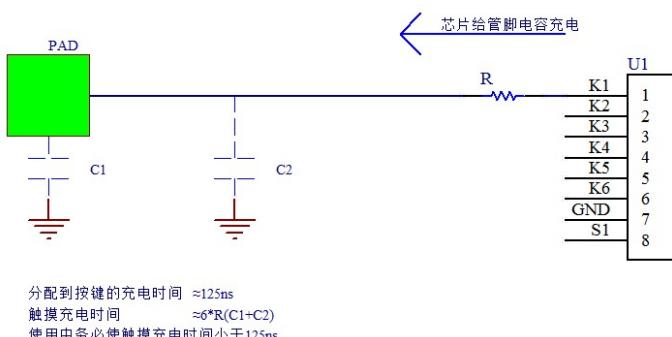
如等效电路图所示，串联电阻R需要与按键对地等效电容（由走线分布电容C2、感应片与外壳形成的固有电容C1等组成）匹配，使其RC充电常数适合IC内部的充放电时间125ns。
