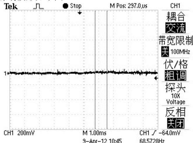
综上所述，建议采用RC滤波后再给触摸IC供电。尤其是系统中有使用1628等驱动数码管的产品应用中！
