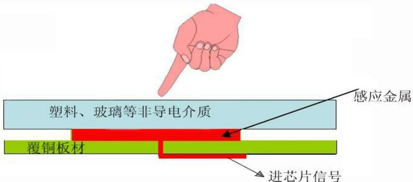
FTC359G是专业的触摸按键处理芯片，采用最新高精度数字电容测量技术，能做到防各种干扰、防面板水迹影响、适应各种电源供电等。其最大能支持到14个触摸按键功能。输出采用类似红外遥控格式的编码，使用1根线通讯，用户可以调整灵敏度。适用各种电器、数码类电子产品的应用。
