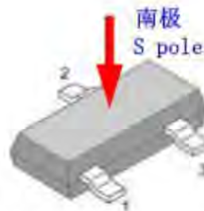
S 极靠近输出低电平
