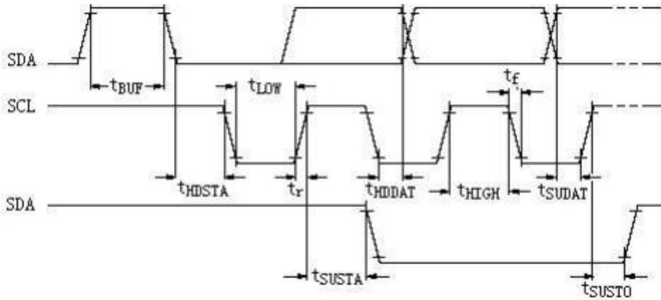
图 4 I<sup>2</sup>C 总线时序波形
