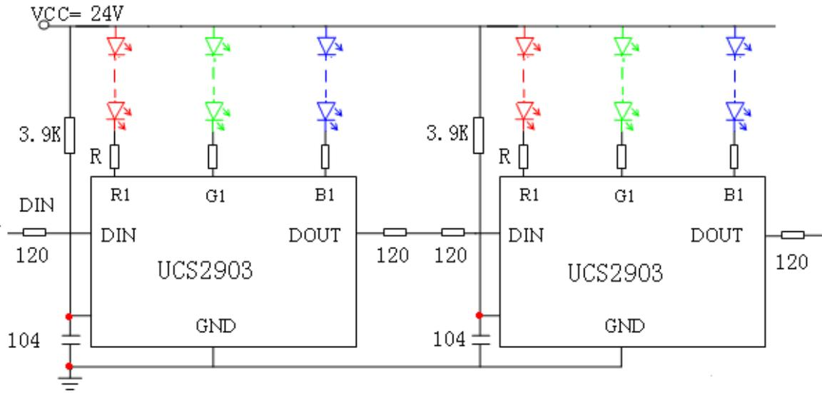
24V 供电时建议在 IC 的信号输入及输出端各串一个 120 的电阻防止带电拔插或电源和信号线错接等情况下损坏 IC 输入及输出端。
