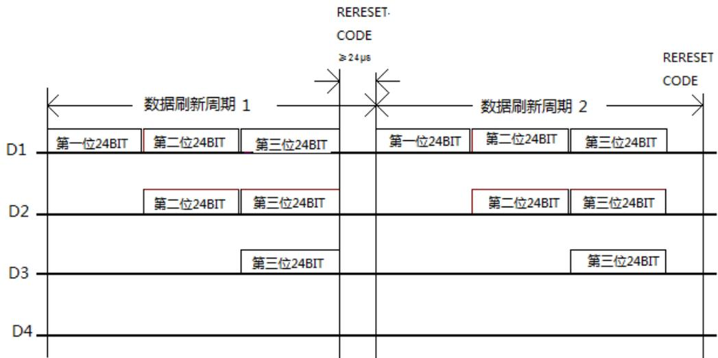
注：其中 D1 为 MCU 端发送的数据，D2、D3、D4 为级联电路自动整形转发的数据。
