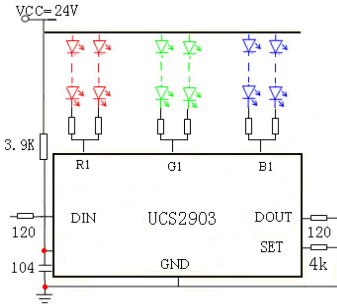
24V 供电时建议在 IC 的信号输入及输出端各串一个 120 的电阻防止带电拔插或电源和信号线错接等情况下损坏 IC 输入及输出端。
