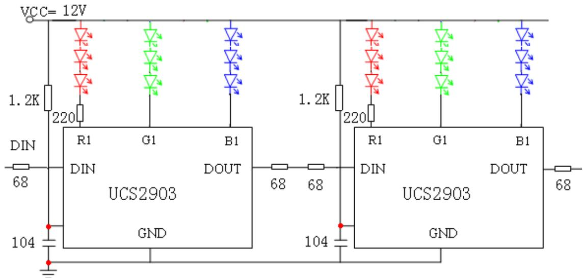
12V 供电时建议在 IC 的信号输入及输出端各串一个 68 的电阻防止带电拔插或电源和信号线反接等情况下损坏 IC 输入及输出端。
