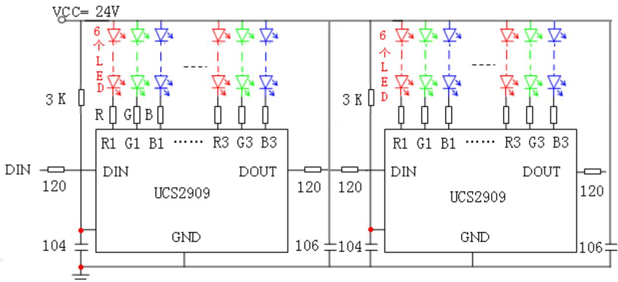
24V 供电时建议在 IC 的信号输入及输出端各串一个 120 的电阻防止带电拔插或电源和信号线错接等情况下损坏 IC 输入及输出端。
