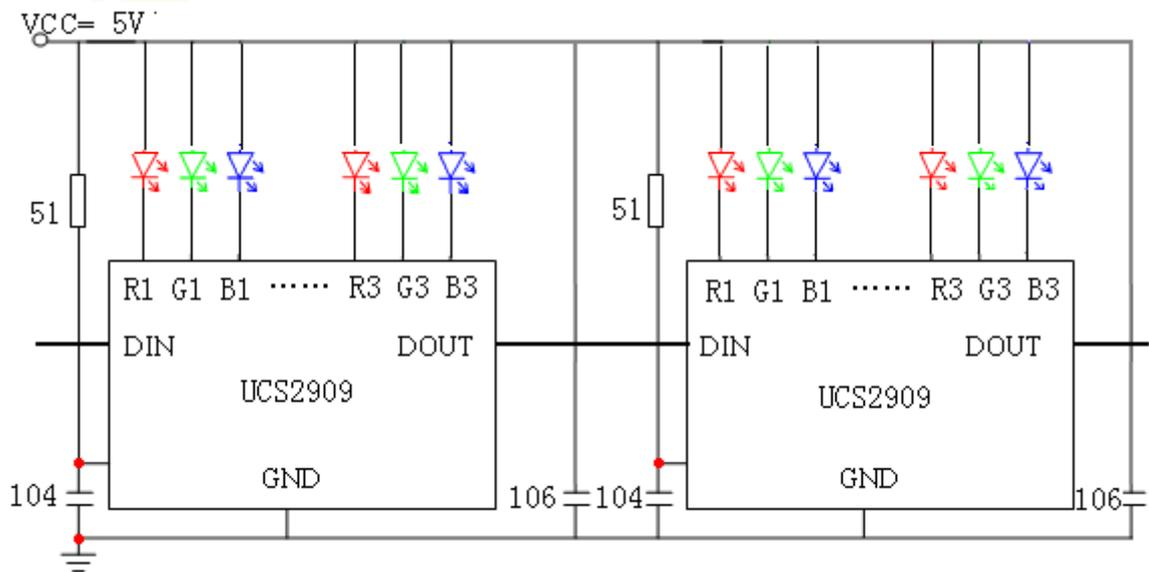
采用恒流方式可以在电压不断下降的同时达到亮度及色温保持不变的理想效果。
