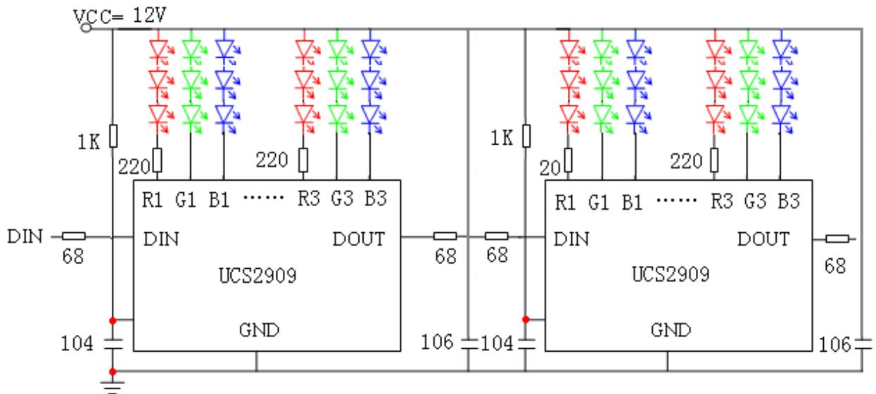
12V 供电时建议在 IC 的信号输入及输出端各串一个 68 的电阻防止带电拔插或电源和信号线反接等情况下损坏 IC 输入及输出端。
