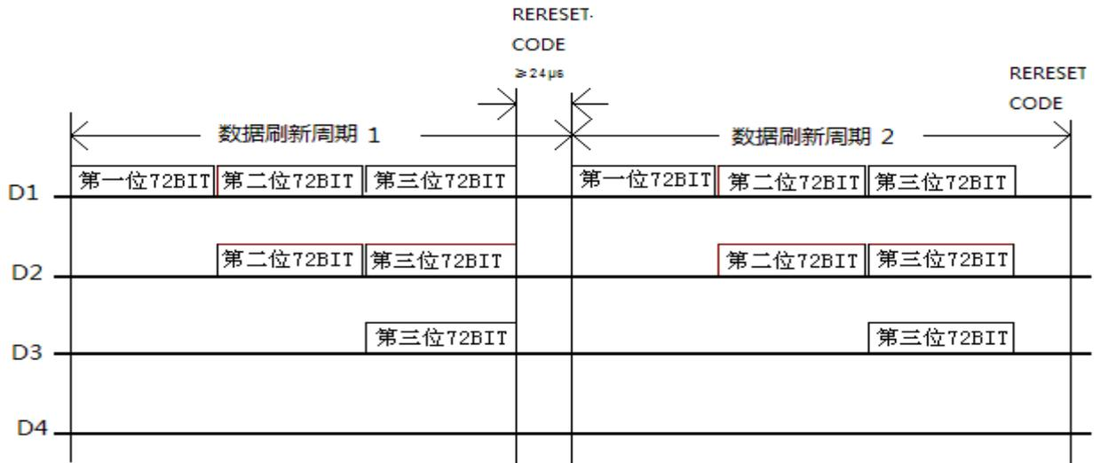
注：其中 D1 为 MCU 端发送的数据，D2、D3、D4 为级联电路自动整形转发的数据。
