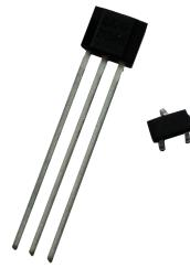
OH9248高灵敏度全极霍尔开关适用于电池供电的便携设备。产品采用CMOS工艺和先进的斩波稳零技术，保证了低电压和低功耗的要求。在电路设计上，OH9248 提供了一个内嵌的受控时钟机制来为霍尔器件和模拟信号处理电路提供时钟源，同时这个受控时钟机制可以发出控制信号，使得消耗电流较大的电路周期性的进入“休眠”模式；同样通过这个机制，芯片被周期性的“唤醒”并且根据预定好的磁场强度值检测外界穿过霍尔器件磁场强度的大小。当存在一定的强南极或北极磁场时面向产品标志面时，电路被锁定在开(Bop)状态，而在无磁场时锁定在关(Brp)状态。
